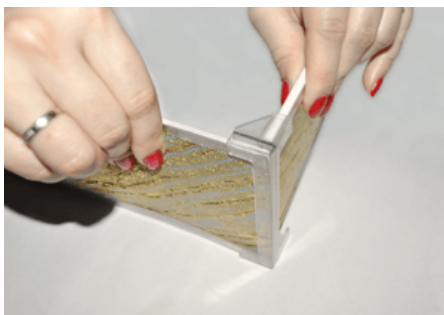
2. Установите боковые элементы ламбрекена в уголок с торцов (если заказано).
